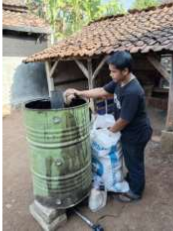
Gambar 5. Memasukkan batok kelapa ke dalam drum reaktor
