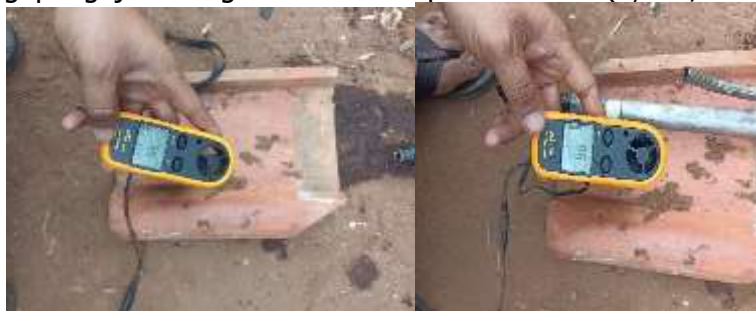
Gambar 9. Pengukuran kecepatan angin
