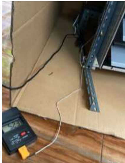
Gambar 6. Suhu Setelah Fan Dinyalakan 52,3°C
