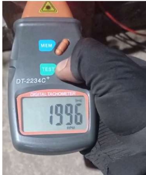
Gambar 4.1 Pembacaan tachometer pada Freewheel
