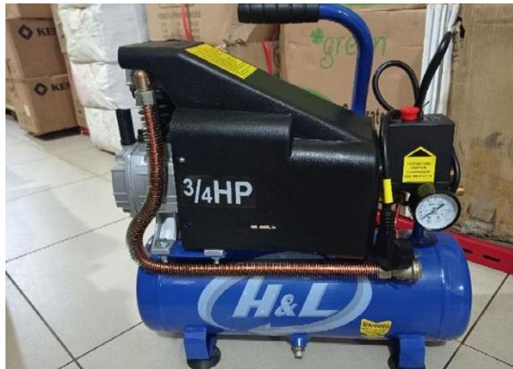
Gambar 2. Kompresor udara 3/4 HP
