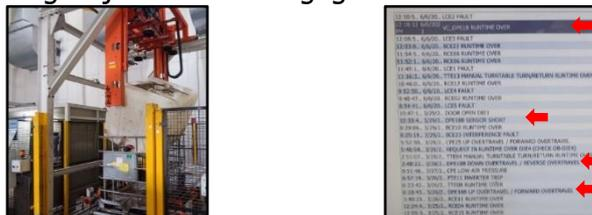
**Gambar 6. Mesin depotting gagal vacuum (error) serta fault message pada panel utama**
