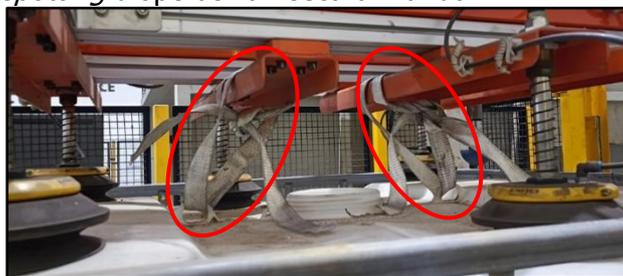
**Gambar 11. Innertank diikat tali pada stand mesin vacuum**
