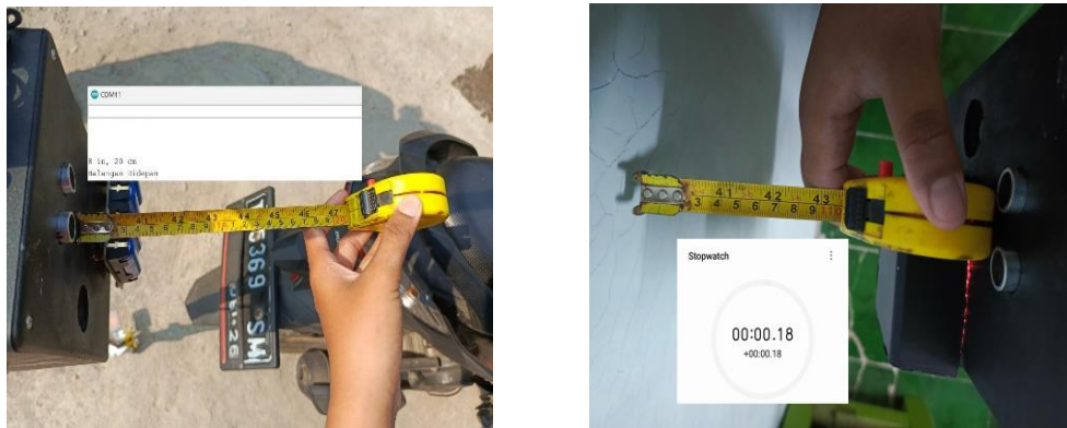
Gambar 7. Pengujian sensor ultrasonik
