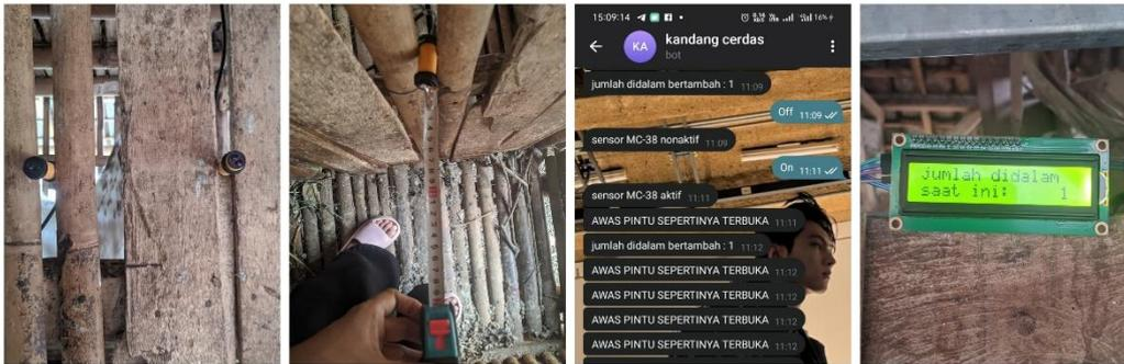
**Gambar 13. Pengujian Sensor E18-D80NK-*Infrared* dan LCD I2C**
