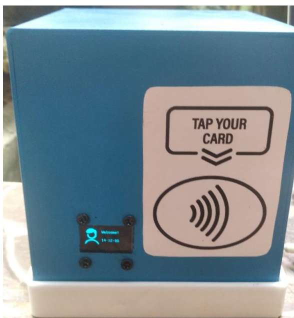
Gambar 9. Pengujian Alat Kartu Id Terdaftar
