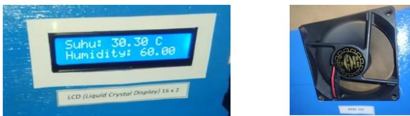
Gambar 11. Kipas 2 hidup suhu  $> 30^{\circ}\text{C}$
