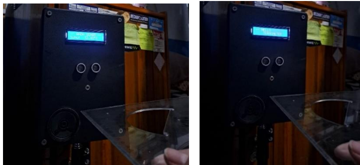
Gambar 8. Pengujian sensor ultrasonik
