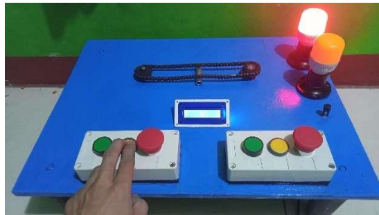
Gambar 12. Kondisi Tombol Kuning Ditekan Buzzer mati
