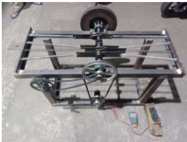
Gambar 2. Rancangan alat penambahan Freewheel gear dan engkol
