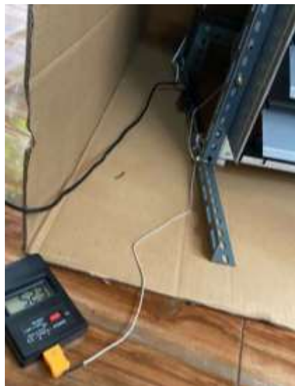
Gambar 6. Suhu Setelah Fan Dinyalakan 52,3°C
