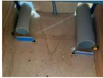
Gambar 9. Hasil perancangan mekanik stopper jalur pembuangan sampah
