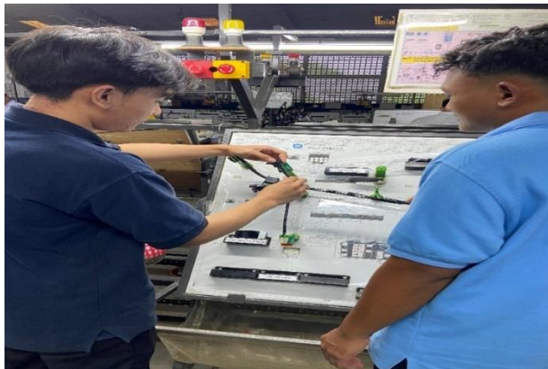
Gambar 9: Penggunaan Jig Board sesuai SOP Sumber: Olah data
