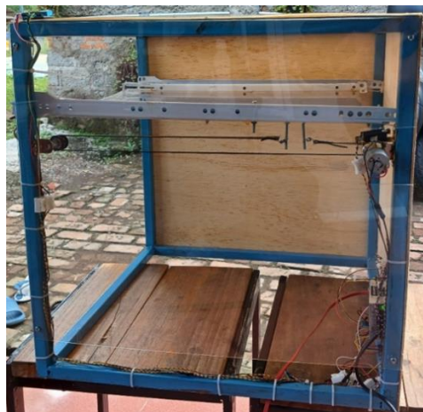
Gambar 3.1 Hasil perancangan mekanik rak jemuran bergerak masuk
