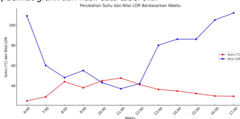
Gambar 3.1 Grafik hasil pengujian perubahan suhu dan nilai LDR berdasarkan waktu
