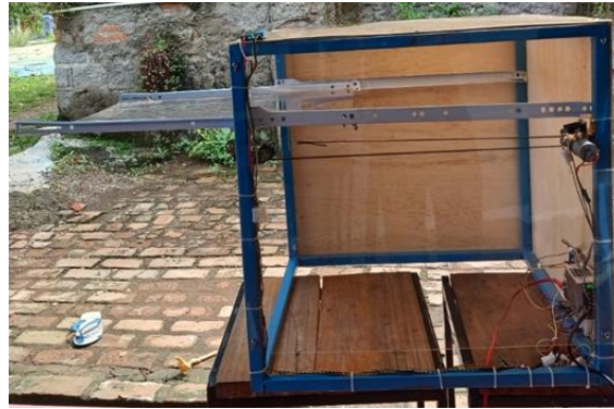
Gambar 3.2 Hasil perancangan mekanik rak jemuran keluar
