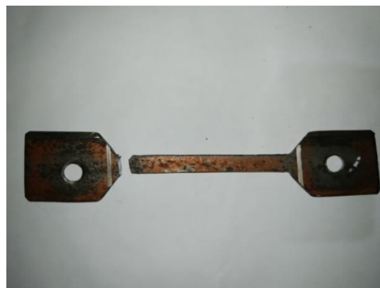
Gambar 6. Kondisi Spesimen Sesudah Uji Tarik
