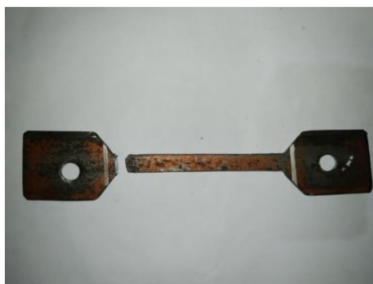
Gambar 6. Kondisi Spesimen Sesudah Uji Tarik
