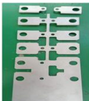
Gambar 3.4. Layout blanking dan bending setelah modifikasi
