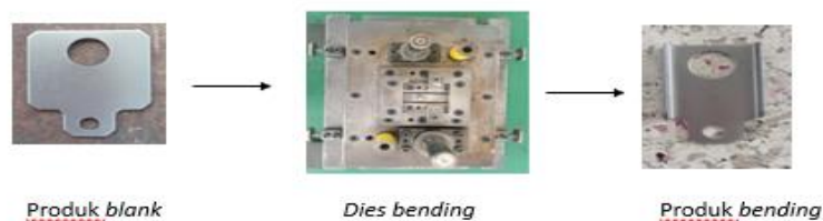
Gambar 3.3. Proses bending sebelum modifikasi
