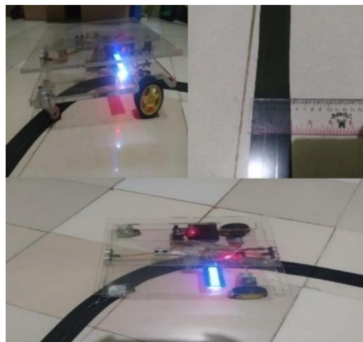
Gambar 3.8 Proses pengujian maju miniatur
